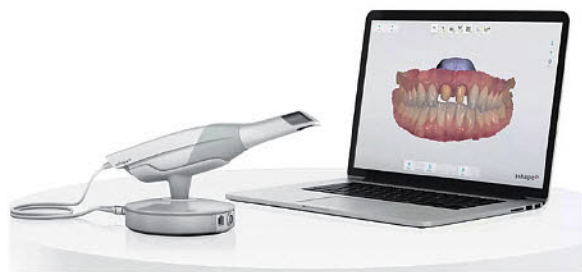
그림3. Trios3 Intra-Oral Scanner (3Shape)
